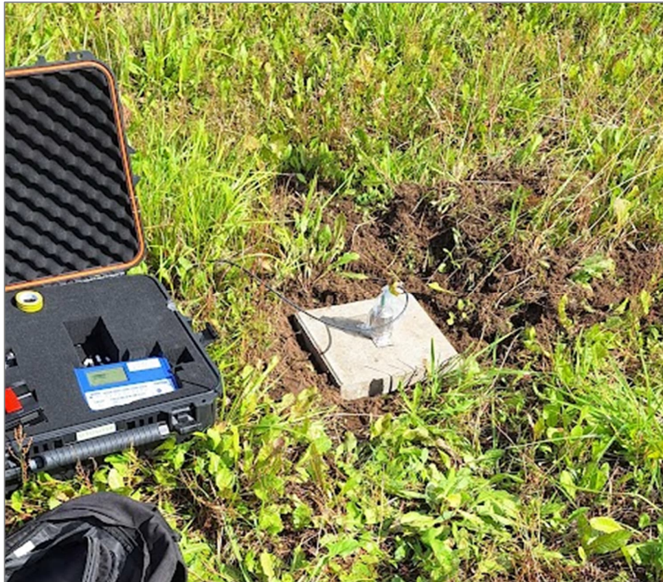
Kuva 3-2 Mittausjärjestelyt kentällä. Kiihtyvyyssanturi sekä tallennuslaitteisto.
