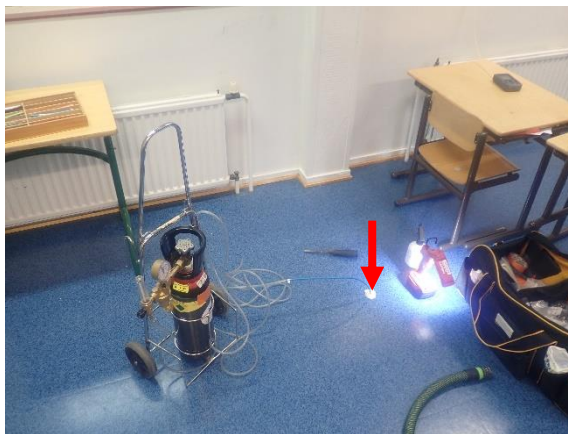
Kuva 62 Tilan 215 välipohjan merkkiainetutkimus. Kaasunsyöttöpiste osoitettu nuolella.
