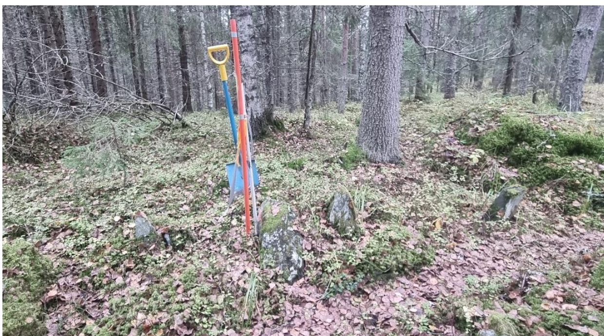
Kuva 2. Neljästä erillistä kivistä muodostuva rajamerkki sijaitsee kiinteistörajojen taitepisteessä.
