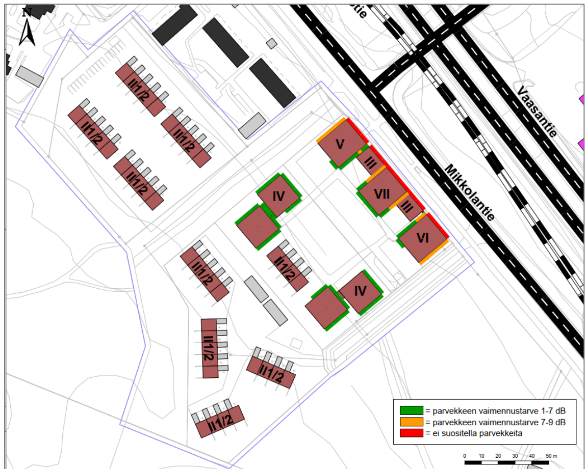
Kuva 6 Parvekkeiden vaimennustarve päiväajan ohjearvon 55 dB saavuttamiseksi.
