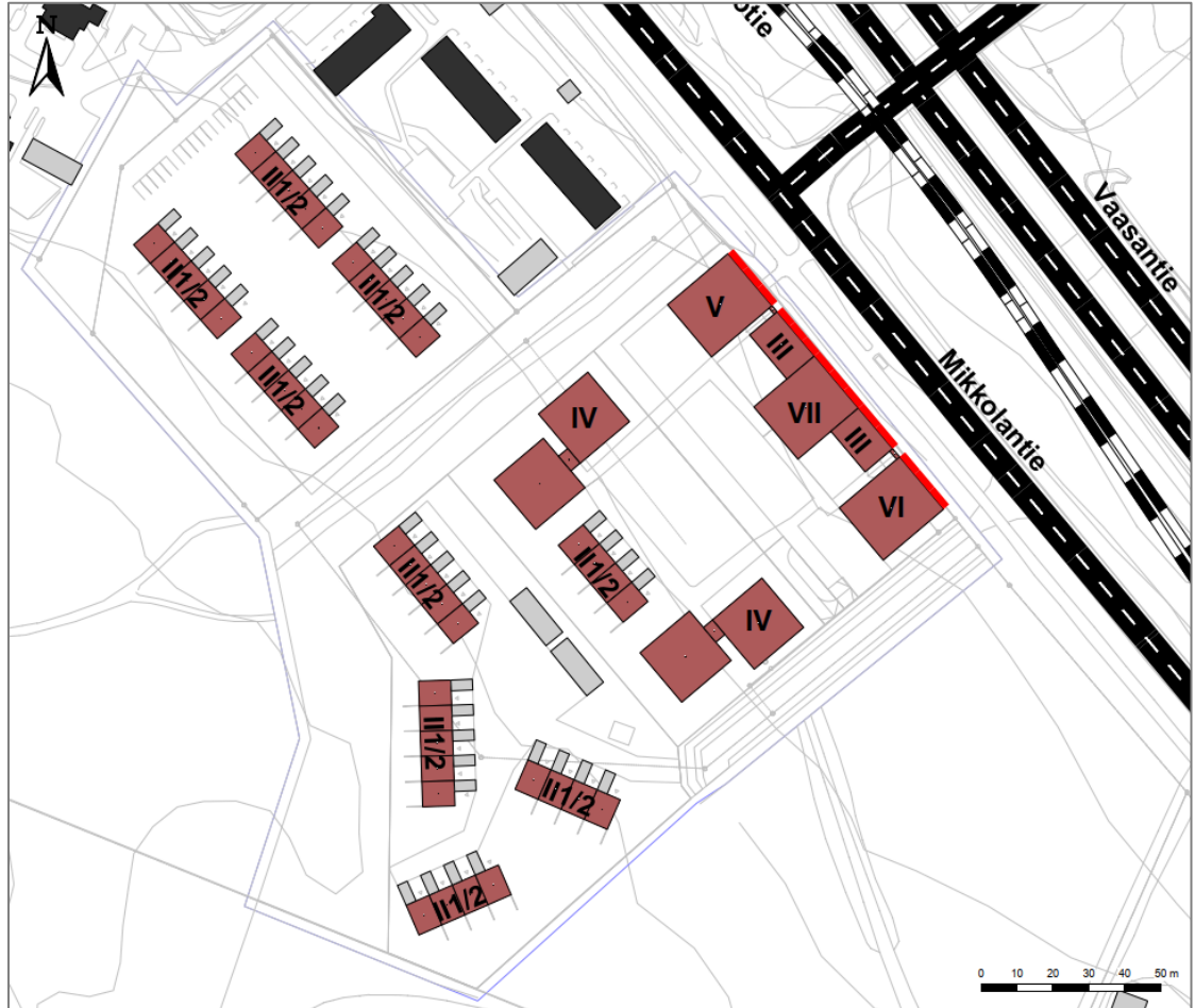
Kuva 5 Lähimpänä Mikkolantietä sijaitsevien rakennusten tien puoleisilla sivuilla ulkovaipan äänitasoero vaatimukseksi suositellaan merkittävän 32 dB. Muilla julkisivuilla äänitasoeroksi suositellaan vähintään 30 dB raideliikenteen hetkellisistä enimmäistasoista johtuen.
