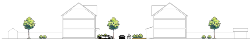
Esimerkki townhouse-korttelista. Etupihan liittyminen katualueeseen on saumatonta. Etupihaa on jäsennelty myös istutuksin. Talousrakennukset sijaitsevat oleskelupihan takaosassa.
