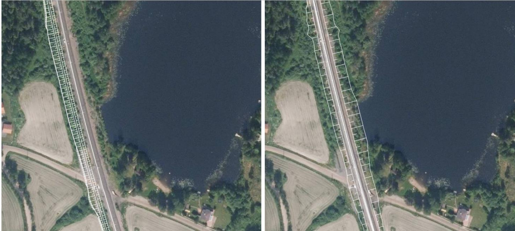
Kuva 17-1. Lepojärven kaarreoikaisun muodostamat ratapenkereet: Oikealla vaihtoehto 2 työntää penkereen Lepojärven rantaa kohti, kun taas vaihtoehdossa 1 ratapenkere sijoittuu radan länsipuolelle pellon suuntaan.
