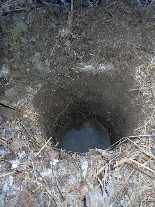
Kuva 2. Pellon laitaan tehdyn koepiston pohjalle nousi nopeasti vesi. Noin 15 cm paksun peltosaven alapuolella on ruskeampi turvemaa, entinen suo (?) ja sen alapuolella savea.
