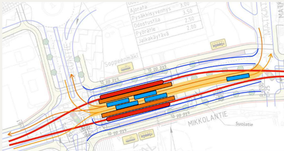
VE2A Vaihtoterminaali kadun keskellä
